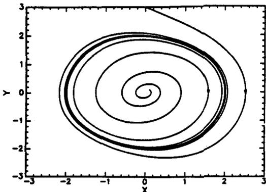
Figure 3. Limit Cycle<sup>4</sup>
